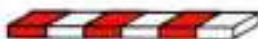
2. เครื่องหมายขอบทางสีแดง-สีขาว (ขนาด ๓๐๐ มม. x ๑๐๐ มม.)
